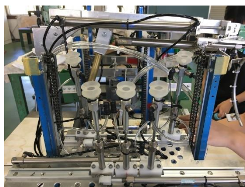
Img2 スライド装置で動く捕獲装置
