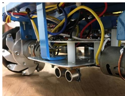
Img4 超音波センサー ロボットへの取り付け
