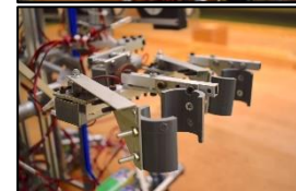
図5 ハサム・ツカム機構
